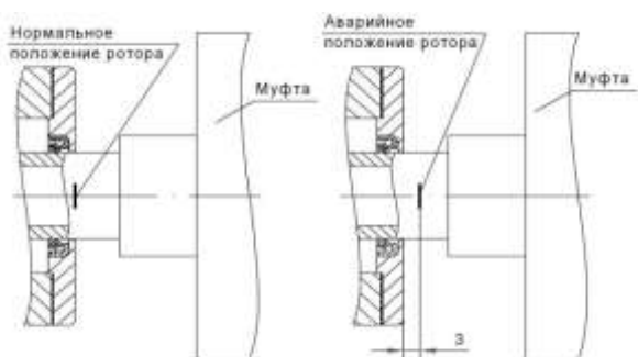
Рис. 9. Установка ротора по риске.
